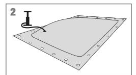
Mit maximal 20% Luft befüllen\* und anschließend auf dem Pool positionieren.
