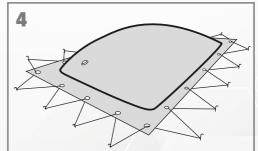
Zum Schluss die noch benötigte Luft nachpumpen, bis die benötigte Form und der gewünschte Härtegrad erreicht sind.
