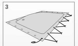
Nun die Poolplane so verspannen und rundum befestigen, dass nur die seitliche Abschweißung über dem Poolrand übersteht.
